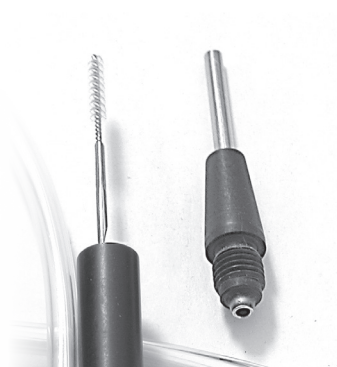
Figura 3: Cappuccio rimosso, che espone lo spazzolino della punta della sonda per la pulizia.
