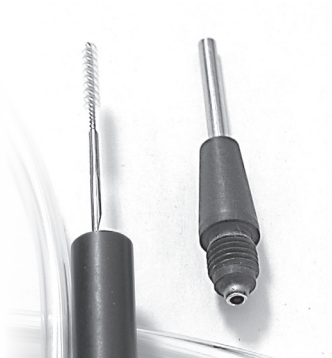
Abbildung 3: Entfernte Verschlusskappe, zur Reinigung freigelegte Bürste der Sondenspitze
