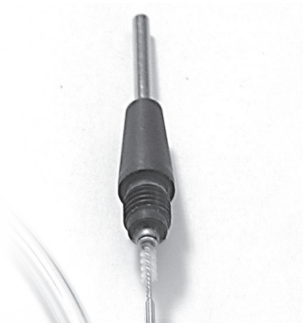
Abbildung 2: Abgeschraubte und teilweise entfernte Verschlusskappe
