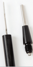
図3:キャップを完全に取り外し、プローブ先端のブラシが見えて掃除できる状態
